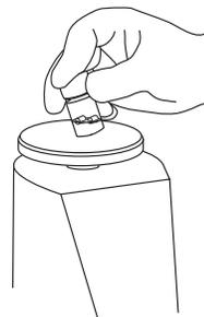
Inmediatamente después de la incubación, coloque en el vórtex el material hidratado hasta que los gránulos se hayan disuelto completamente y la suspensión sea homogénea.
