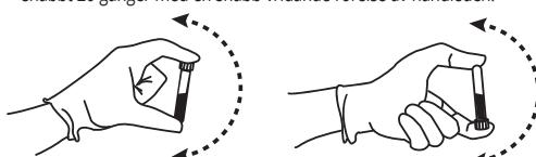
c. Analysera produkten omedelbart efter blandning. Efterföljande analyser under denna analysperiod kan utföras genom att vända flaskan 5 gånger före instrumentanalysen.
