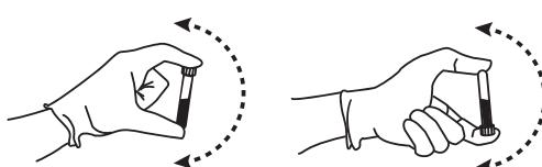
c. Analyser umiddelbart etter blanding. Senere analyser i løpet av denne testperioden kan utføres ved å snu hetteglasset opp ned 5 ganger før instrumentanalyse.
