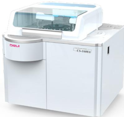
El analizador de bioquímica CS-1600 es un analizador de la serie DIRUI CS. Diseñado con tecnología avanzada para mejorar la eficiencia del laboratorio, la rentabilidad, el aumento de la eficiencia y la estabilidad detectables. Puede ajustarse a laboratorios de nivel medio y alto con un excelente rendimiento de 1350 Muestras/hora con prueba ISE.
