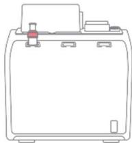
**4a** Insertar R1 en el canal del analizador
